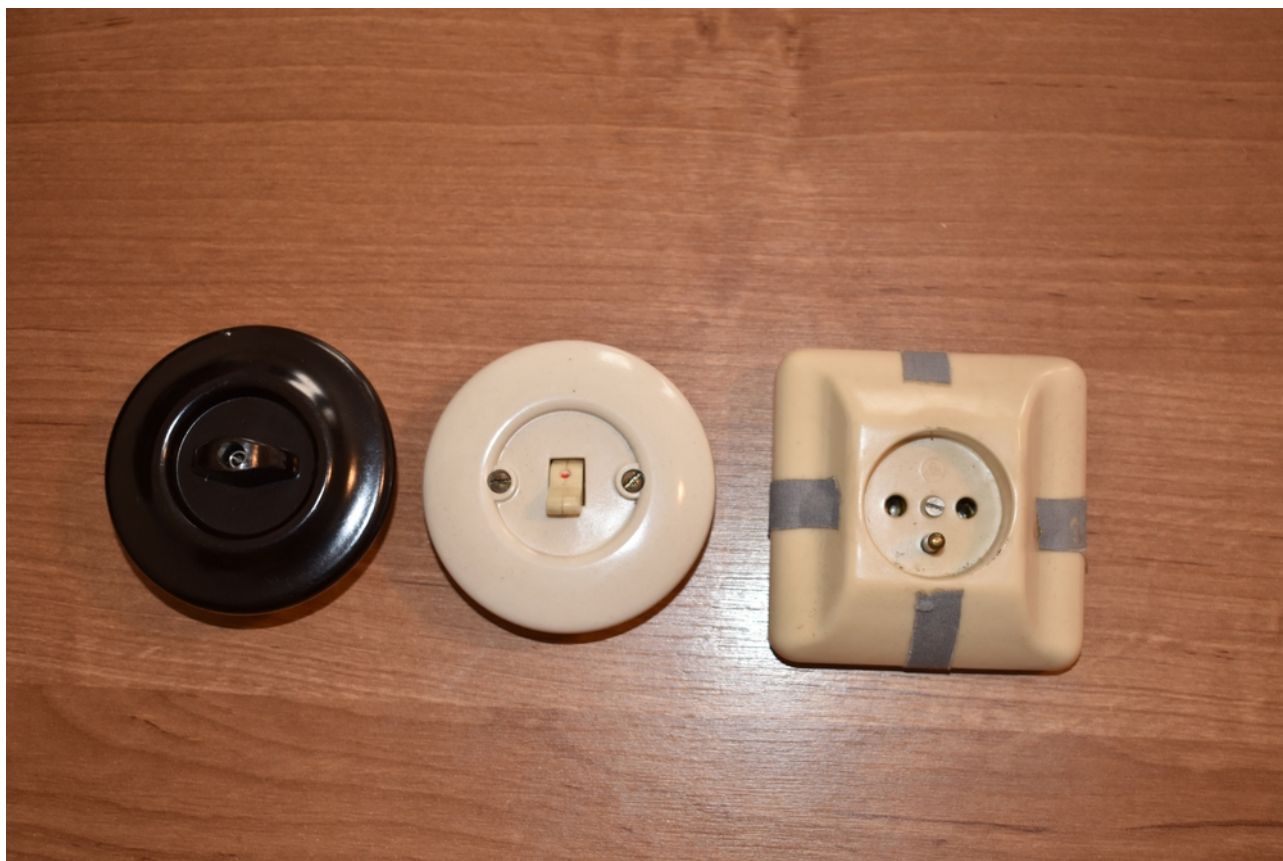
historické vypínače a zásuvka odpovídající dané době
